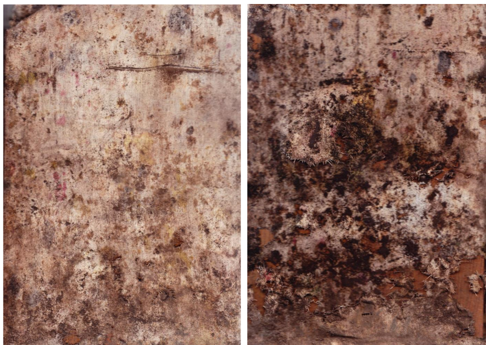
Рис. 3. Ступінь розкладення лляної тканини у варіанті Сидерація II на 30-ту добу ґрунтової інкубації (зліва) та на 60-ту добу ґрунтової інкубації (справа), 2025 рік
