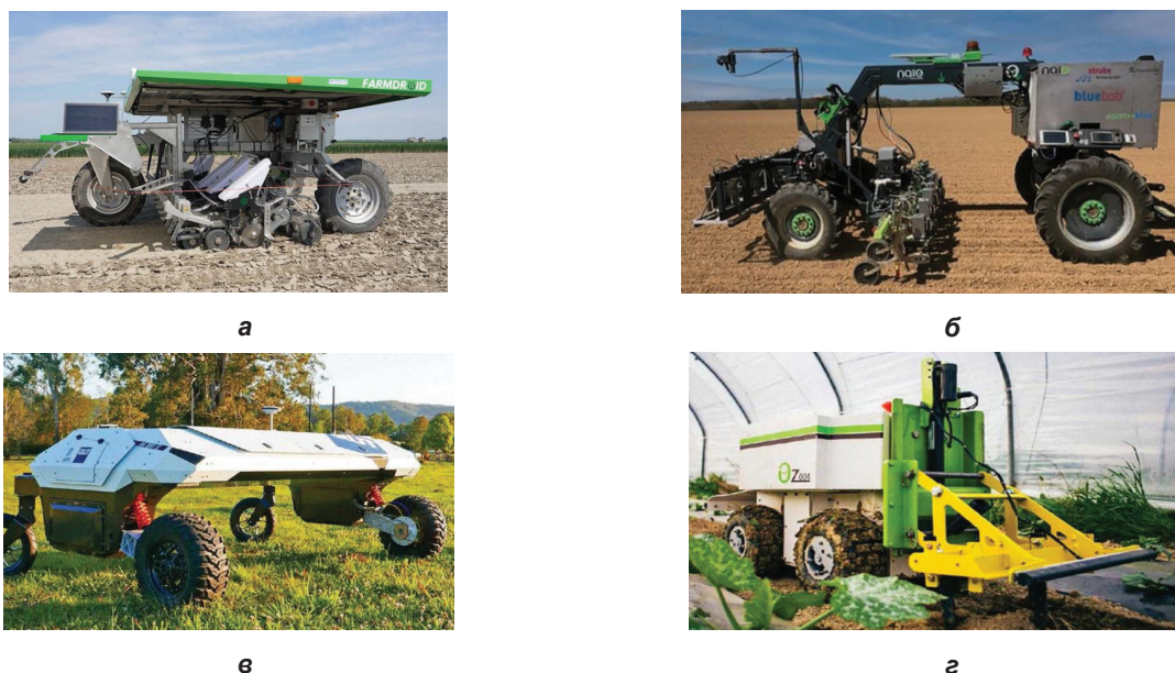
Рис. 2. Загальний вигляд агророботів для міжрядної обробки та боротьби із бур'янами: а – Farmdroid; б – BlueBob 2.0; в – AgBot II; г – Oz
